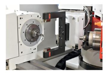
1 Berührungsloses Messen von Präzisionswerkzeugen mit Lasermesstechnik, integriert auf Studer-Schleifmaschinen © Studer
